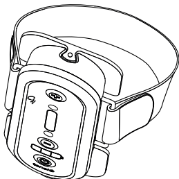
Bevestiging met één deel van de riem (lange deel)
