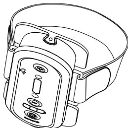
Montaje con una parte de la correa (parte larga)
